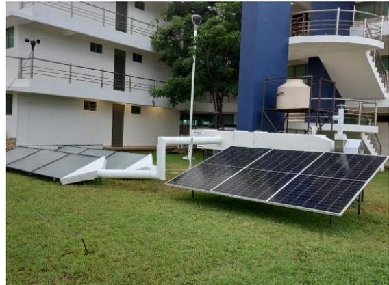
Figura 2: Prototipo de secador solar con hibridación de tecnologías solares
