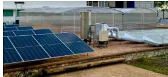
**Figura 2:** Prototipo de secador solar con hibridación de tecnologías solares
